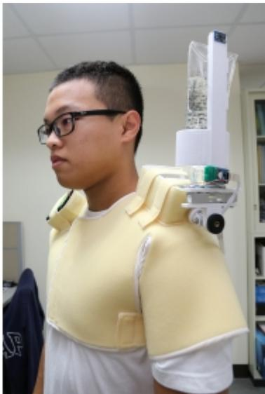
↑ 背負式點滴架設有角度監測與補償機制，吊掛可維持在垂直地面狀態，減少動作而產生的回血
